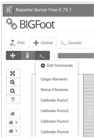
La calibración de la impresora es fundamental para que el funcionamiento de la misma sea óptimo y para conseguir impresiones de calidad. Consiste en nivelar la cama y sobre todo que la distancia entre la boquilla del cabezal y la cama sea idónea.
