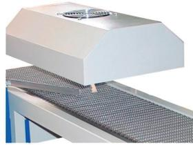
Equipado con una campana con una fuente de calor infrarrojo
