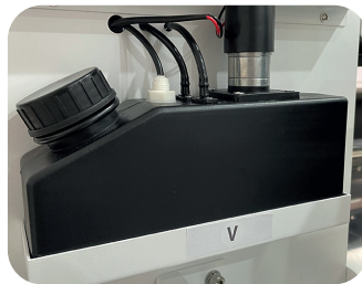
Depositos de barniz y blanco con agitador
