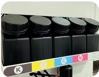
Depositos de tintas industrial. Recarga tinta sin parara la impresión
